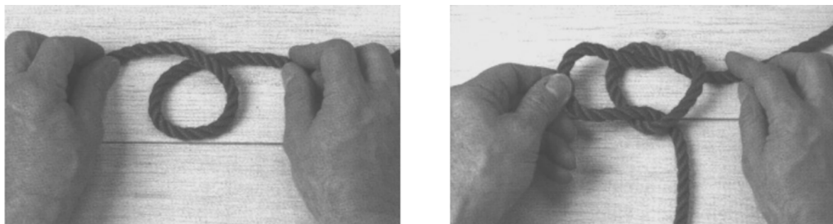
Figure C-1 Étapes 1 et 2 de la chaîne simple
