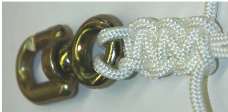
Figure 6 Étape 5 (Tresse portugaise plate)
