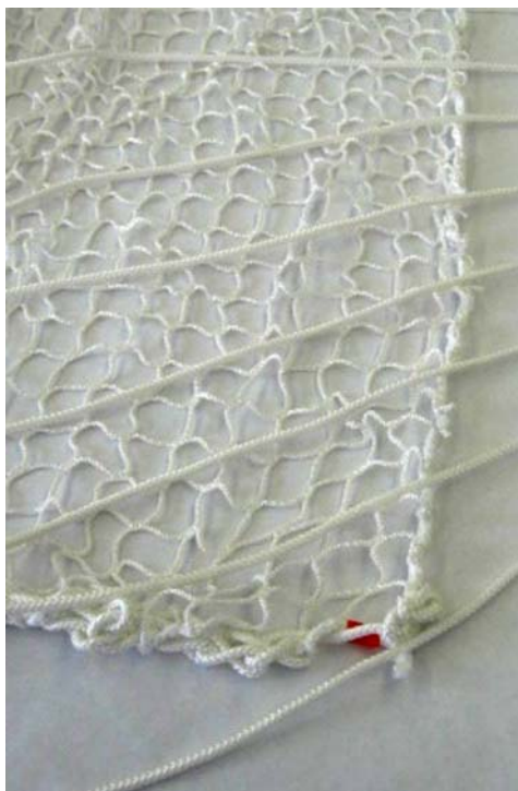
Figure 15 Bout de corde chevauchant le filet
