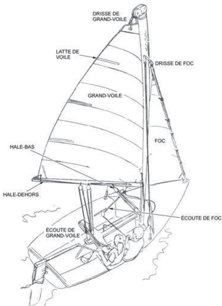
Figure 15-4-1 Voiles et parties comprises dans le grément courant
