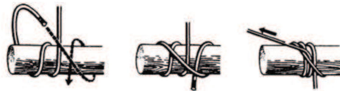
Figure 15D-1 Étapes pour faire un nœud de fouet
