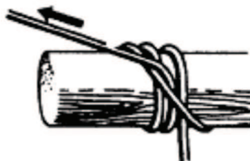
Figure 15-3-2 Nœud de fouet terminé
