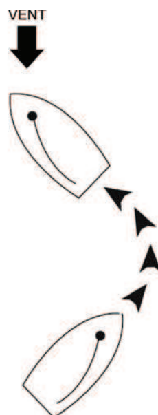
Figure 15-9-7 Virement de bord
