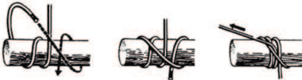
Figure 15-3-3 Étapes d'un nœud de fouet
