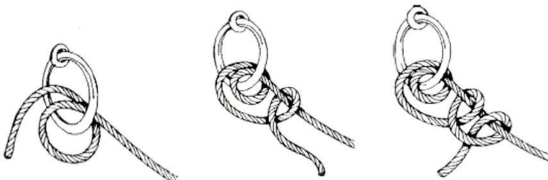
Diagramme 6 Tour mort et deux demi-clés DCFC 105 Fleet Seamanship Rigging and Procedures Manual
